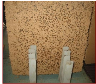
การวางแผ่นปาร์ติเกิลที่อัดเสร็จเพื่อปรับสถานะ
